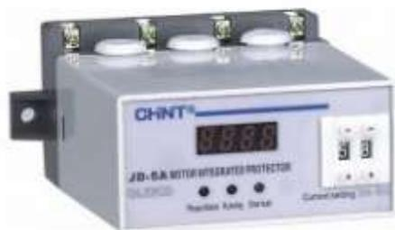
Комплексное защитное устройство для двигателей JD-5A (далее – защитное устройство) применяется для защиты двигателя переменного тока от перегрузки, обрыва и несимметрии фаз. Рабочая частота – 50 Гц, номинальное напряжение изоляции до 690 В, номинальная сила тока – 1–400 А. Возможна работа в непрерывном или прерывистом режиме
