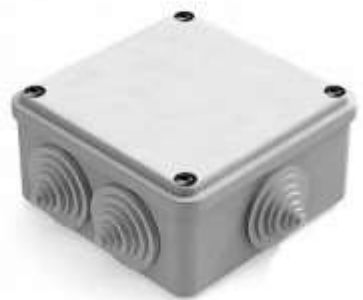
8820015 Коробка распаячная для наружного монтажа, RAL 7035, 6 гермовводов, 100x100x50мм, IP44 (CHINT)
