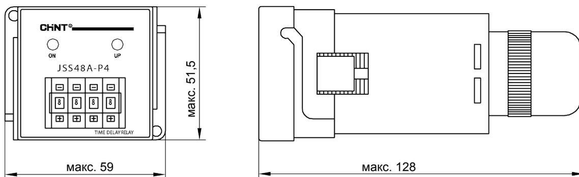
Рис. 2. Габаритные размеры JSS48A-P
