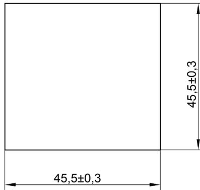
**Рис. 4. Размеры монтажного отверстия
