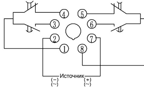
**Рис. 6. Тип проводки JSS48A-2Z/
