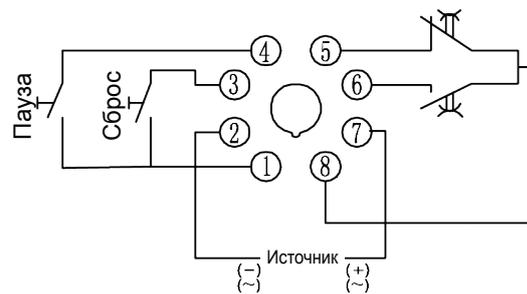
**Рис. 8. Тип проводки JSS48A-S**
