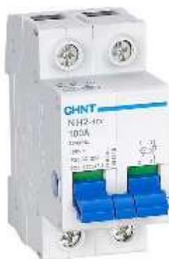
Выключатели нагрузки серии NH2, которые применяются для оперативного разъединения и соединения электроцепей с номинальным напряжением до 400 В. Эти устройства не обеспечивают защиту цепи — для решения этой задачи следует использовать модульное оборудование. Выключатели рассчитаны на быстрый монтаж и фиксацию на DIN-рейке. Конструкция изделий минимизирует риск пробоя и перекрытия дугой по изоляции, снижает тепловые потери, а также увеличивает механическую прочность соединения.
