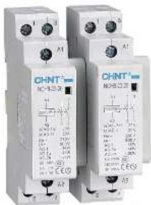
модульные электромагнитные контакторы, рассчитанные на тепловой ток от 20 до 63 А. Устройства отличаются оптимальной стоимостью, соответствием требованиям ГОСТ Р 51731-2001, а также электрической и механической износостойкостью. Контактторы предназначены для коммутации слабоиндуктивных нагрузок в зданиях жилого и промышленного назначения. Устройства используются в системах автоматизации и управления освещением, вентиляцией, кондиционированием и технологическими процессами.
