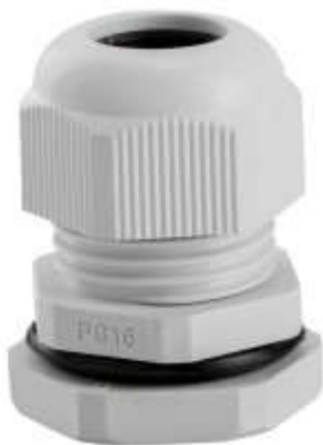
9905934 Сальники PG-7 диаметр проводника 2.5-7мм IP54 - белый
