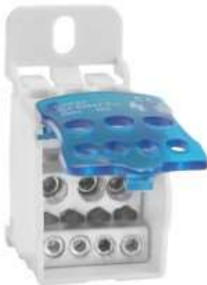
9900192 Распределительный блок на DIN-рейку РБ-400 1П 400А (1x185/2x35+5x16+ 4x10)
