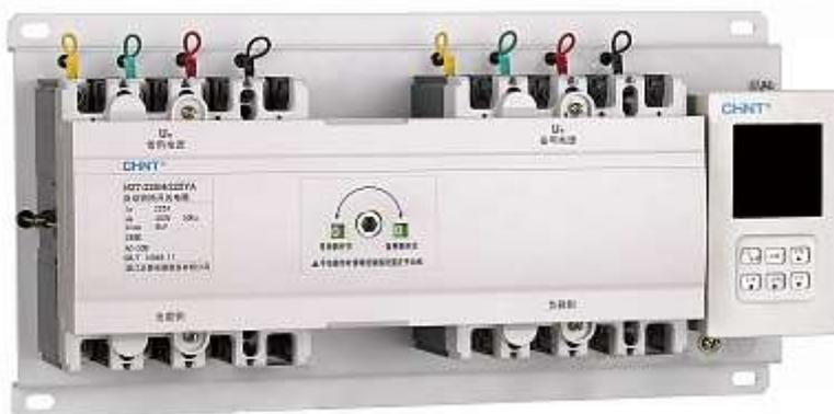
NZ7 предназначено для автоматического перехода на резервный ввод в сетях переменного тока частотой 50 Гц номинальным рабочим напряжением до 400 В и номинальным током от 16 А до 630 А, а также управление и автоматический переход на дизель-генератор.
