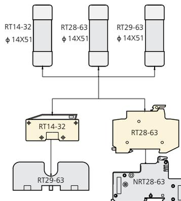
Совмещенные схемы соединений держателя (корпуса) плавкого предохранителя и плавкой перемычки (размер 22 × 58)
