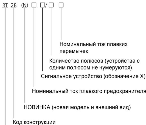
Код плавкого предохранителя с наполненным порошком картриджем
