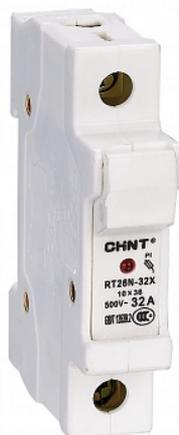
Плавкие вставки цилиндрические RT28 применяется для защиты от пере грузки и коротко го замыкания в распределительном оборудовании с рабочей частотой 50 Гц, номинальным напряжением 500В и номинальным током не более 63 А (в конденсаторных блоках вместо данного устройства рекомендуется применять плавкие предохранители RT36-00). На корпусе плавкой вставки имеется сигнальное устройство (обозначение X), которое состоит из неоновой лампы и резисторов.
