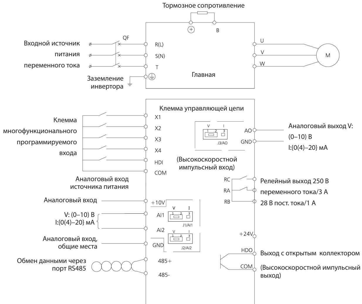
Соответствует разводке управляющих клемм
