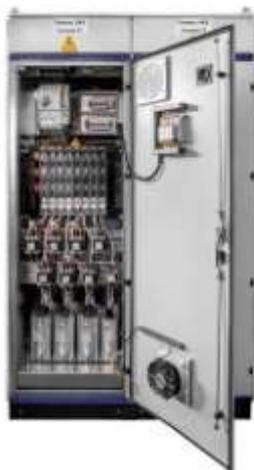
АУКРМ — это автоматическая установка компенсации реактивной мощности. Такие устройства позволяют в автоматическом режиме поддерживать заданный коэффициент мощности посредством отключения или подключения ступеней конденсаторных батарей. Системы АУКРМ в основном используются в промышленных электрических сетях, поскольку работа асинхронных двигателей без принятия мер компенсации часто становится причиной падения коэффициента мощности.
