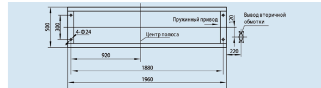
Рис. 6.3 Монтажные размеры выключателя ZW7-40.5
