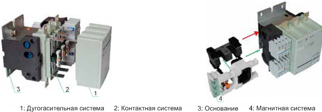
Конструкция контактора NC2-115~265
